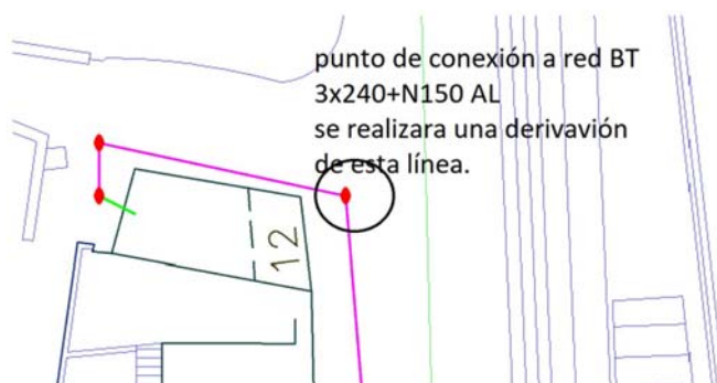
Ilustración 13 Punto de conexión a red en margen izquierda
