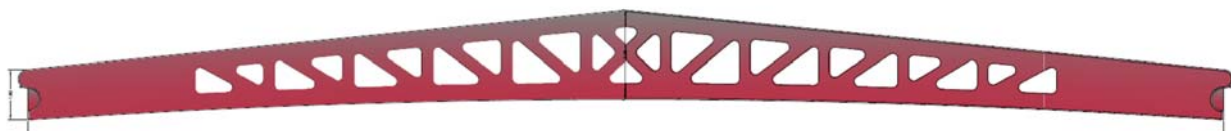
Ilustración 3 Viga de canto variable biapoyada aligerada
